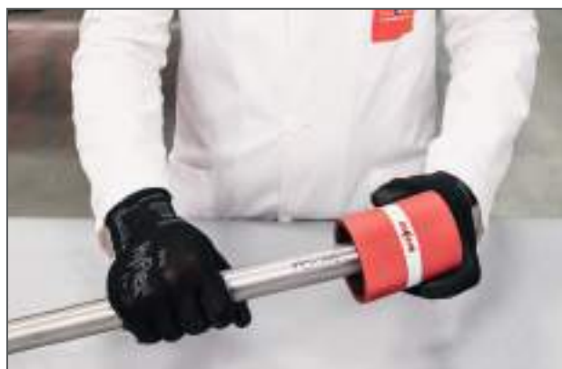
Sbavatura del tubo / Deburring the pipe
